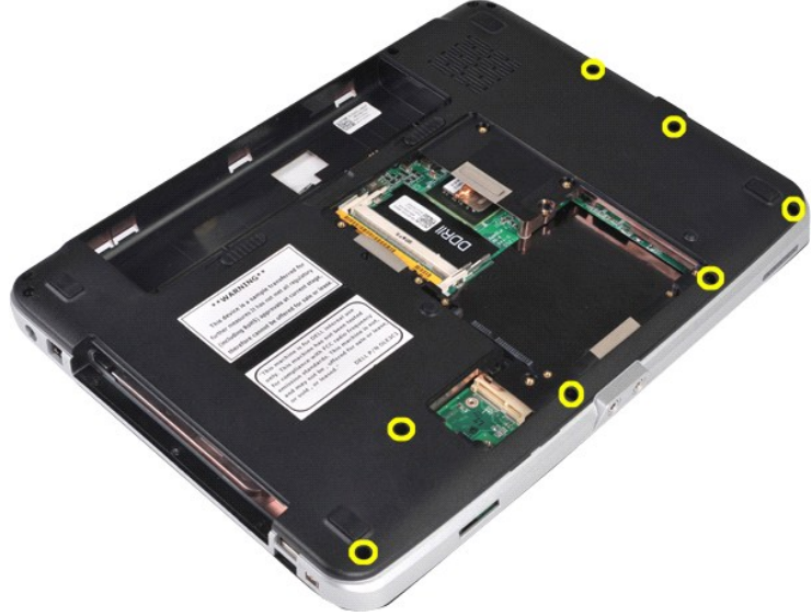
11. قم بفتح المسامير الالوانية التي تعمل على إحكام تثبيت مسند راحة اليد بعلبة الوسائط.
