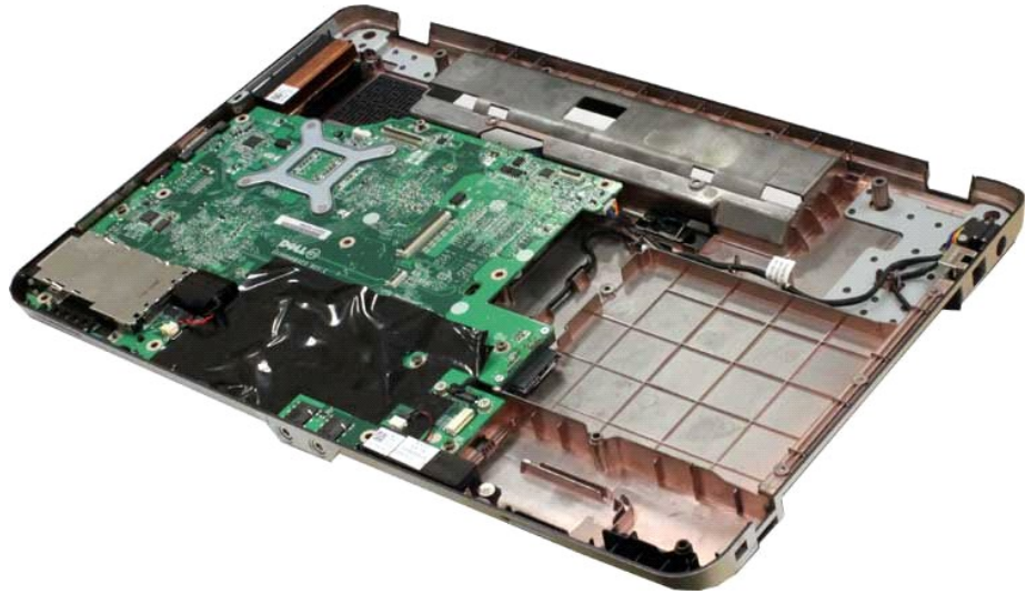
61. فصل كبلات مكبر الصوت عن لوحة النظام.
